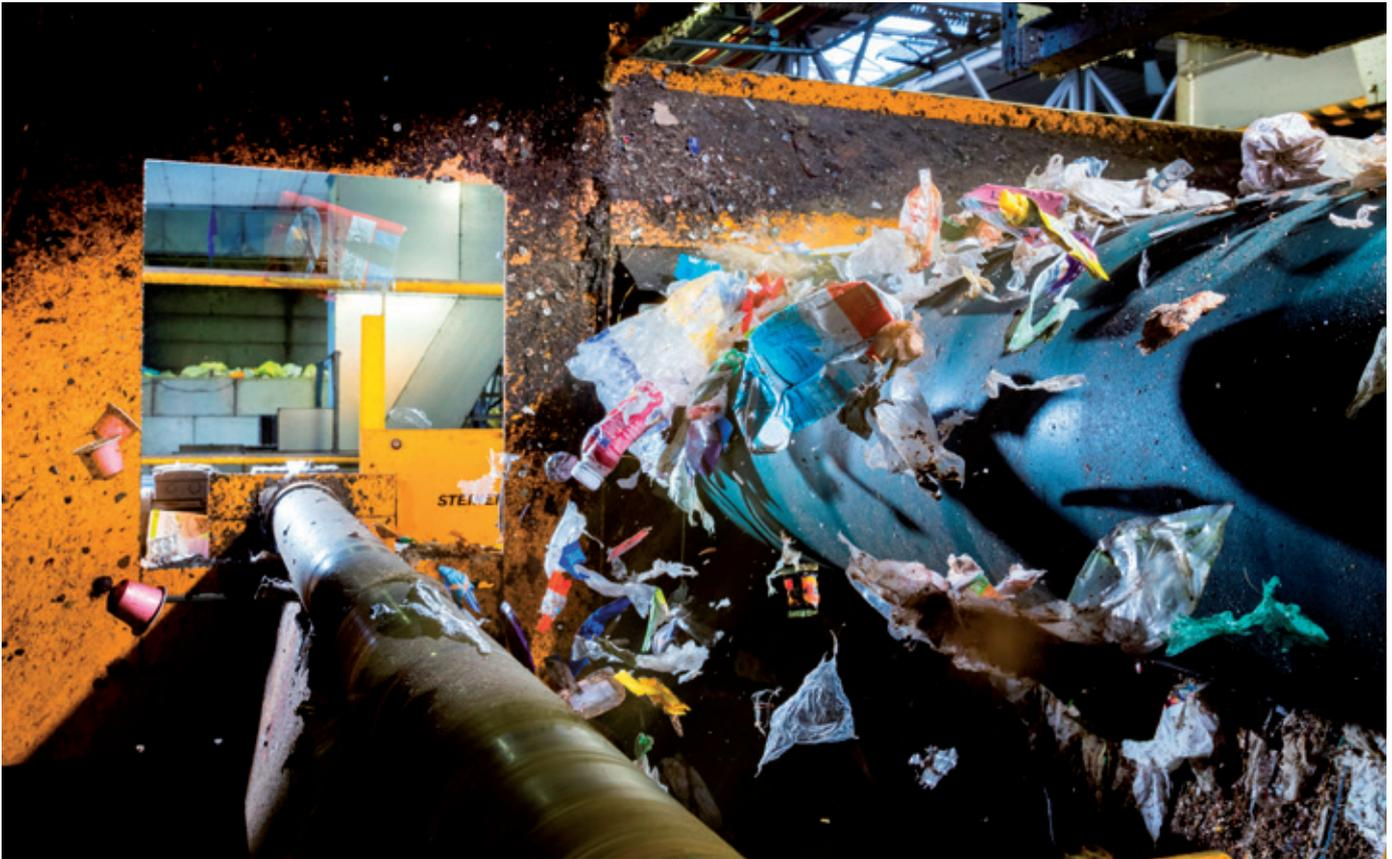
Über Wirbelstromscheider werden Kaffeekapseln aus Aluminium zuverlässig richtig sortiert
